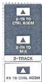
Fig. 2.12: Interruptor de atribuição da secção principal
